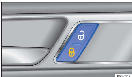
Fig. 52 En la puerta del conductor: tecla del cierre centralizado.
