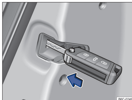
Fig. 56 En las puertas, delantera derecha y traseras: bloqueo de emergencia del vehículo con la varilla metálica de la llave (variante 2).
