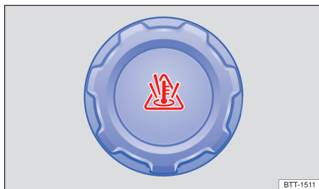
Fig. 187 En el compartimento del motor: tapa del depósito de expansión del líquido refrigerante del motor.
