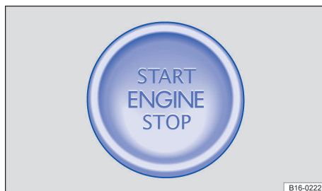
Fig. 89 En la parte inferior de la consola central: tecla de arranque para poner en marcha el motor
