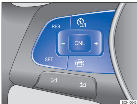
Fig. 99 Lado izquierdo del volante multifunción (variante 1): teclas para controlar el limitador de velocidad.
