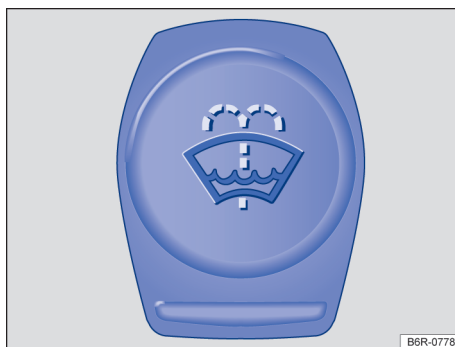
Fig. 183 En el compartimento del motor: tapón de cierre del depósito de agua de los lavacrystales.
