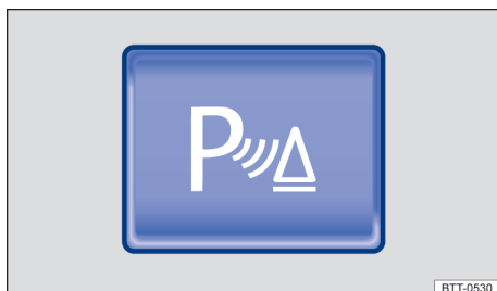
Fig. 107 En la consola central o en la pantalla de la radio: tecla para encender y apagar la ayuda de aparcamiento (dependiendo del equipamiento del vehículo).
